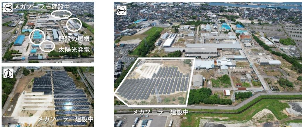
工場敷地内南東部に **900 kW** の太陽光発電設備（メガソーラー）を現在建設中であり、2024年末完成予定です。本設備の完成により、工場敷地内の全ての太陽光発電設備にて **1 MW** の発電が可能となります。
